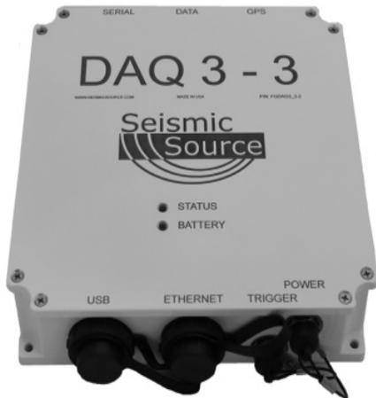
DAQ3-3 - это переносной сейсмограф нового поколения, который может быть сконфигурирован как автономная мониторинговая система или как распределенная система регистрации сигналов.
